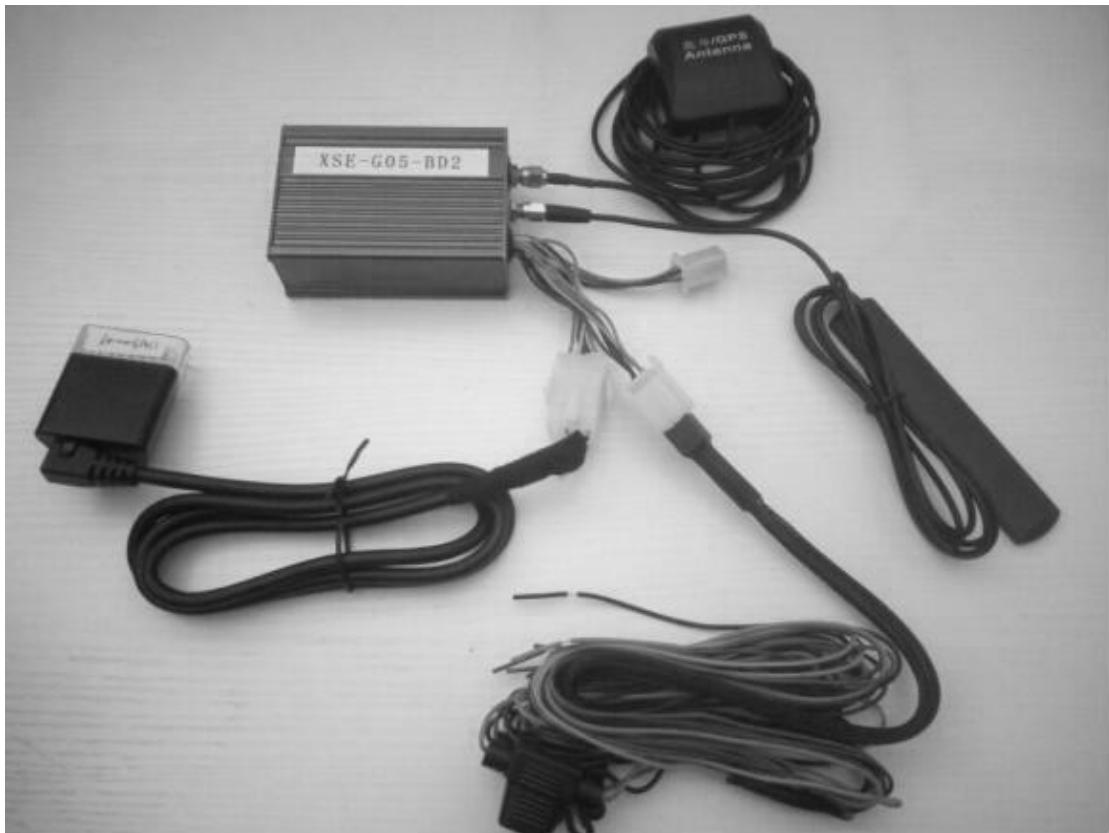
车载 GNSS 主机、天线、OBD 模块连接示意图
